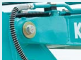
Forjado delantero del boom
