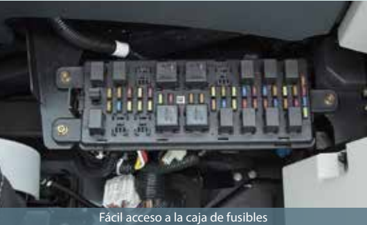
Fácil acceso a la caja de fusibles Los fusibles finamente diferenciados hacen más fácil la localización de fallas.
