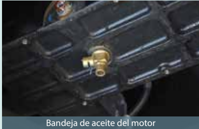
Bandeja de aceite del motor Bandeja de aceite del motor equipada con válvula de desagüe.
