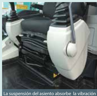
La suspensión del asiento absorbe la vibración
