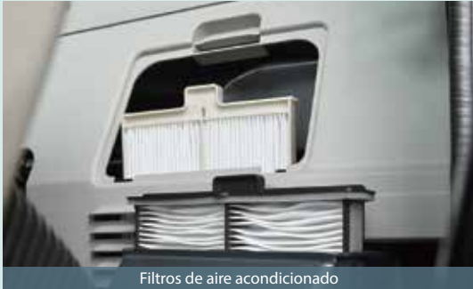
Filtros de aire acondicionado Los filtros internos y externos del aire acondicionado pueden ser fácilmente removidos sin herramientas para limpiarlos.
