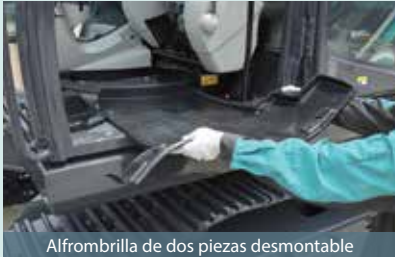
Alfombrilla de dos piezas desmontable Alfombrilla de dos piezas desmontable con empuñaduras para fácil remoción. Un desagüe en el piso está ubicado abajo de la alfombrilla.
