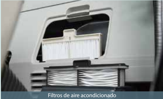
Filtros de aire acondicionado
