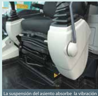
La suspensión del asiento absorbe la vibración
